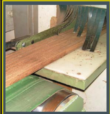
Das Hartholz wird mit dem gewünschten Profil gehobelt. Nicht alle Dielen kommen sauber raus, was technisch unmöglich ist.
