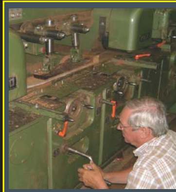
Die schwere Hartholzhobelanlage wird justiert. Normale Hobelgeschwindigkeit 80 m pro min, bei Hartholz 8m pro min.
