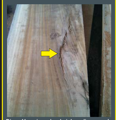
Diese Herzrisse durchziehen dieses mal den ganzen Baum. Fazit: Der Baum ist nur bedingt nutzbar. Bezahlt aber zu 100%
